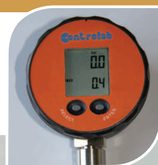
Détail du manomètre
