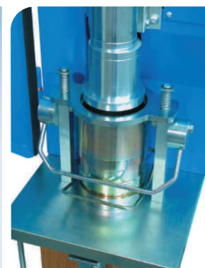
Détail du système de fixation du moule
